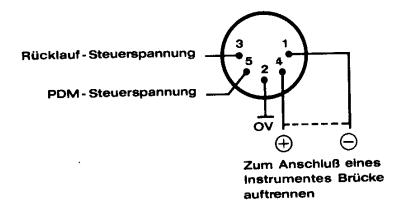
Zur Fernanzeige - z.B. in Regietischen - läßt sich in Serie zum eingebauten Anzeigeinstrument ein zweites, externes Meßwerk anschließen. Dazu wird die Brücke zwischen den Stiften 1 und 4 des 5-poligen Tuchelsteckers, der in der Buchse INSTRUMENT MONITOR steckt, entfernt und der Stift 1 mit dem -Pol, der Stift 4 mit dem +Pol des externen Meß-werkes verbunden.
