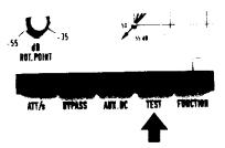
Durch Drücken der Taste TEST läßt sich die Symmetrie des Multiplikators überprüfen und abgleichen. Dazu wird an die Ausgänge der beiden Kanalverstärker ein Pegelmesser angeschlossen. Die Eingänge müssen offenbleiben. Die Symmetrier-Regler BAL. (auf der Geräterückseite, neben den Ausgangsbuchsen) werden so eingestellt, daß die Pegel an beiden Ausgängen ein Minimum werden (etwa 30 mV).
