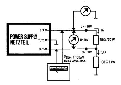
Wurde der Fehler behoben, darf das Netzteil aber nun keineswegs wieder eingesteckt und durch die Printplatten belastet werden, da eine fehlerhafte Printplatte erneut zu Defekten im Netzteil führen könnte. Man zieht vielmehr alle Printplatten - auch die Amplifier-Multiplier-Einschübe - heraus und prüft jede einzelne z.B. mit einem Ohmmeter zunächst auf Kurzschlußfreiheit.
