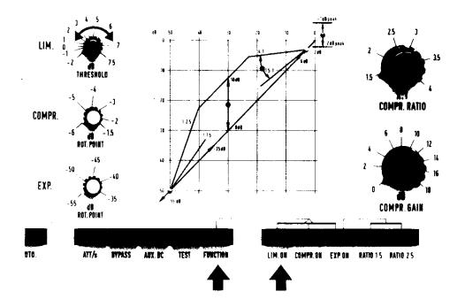
Das Gerät arbeitet als Limiter (Begrenzer). Der Limiter spricht auf die Spitzenwerte des Programmaterials an. Dabei werden alle Pegelwerte, die am Eingang des Gerätes einen bestimmten einstellbaren Schwellwert überschreiten, am Ausgang konstant auf diesem Schwellwert gehalten, indem für Pegel über dem Einsatzpunkt des Limiters (THRESHOLD) die Verstärkung im selben Maße abnimmt, wie der Eingangspegel ansteigt.
