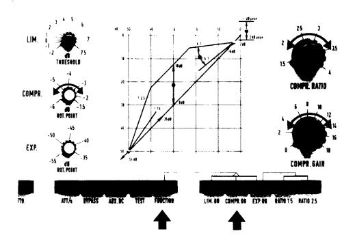
Das Gerät arbeitet als Kompressor. Der Kompressor spricht auf die Mittelwerte des Programmaterials an. Dabei können 3 statische Parameter an der Frontplatte des Gerätes variiert werden.
