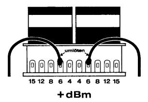
Danach setzt man die beiden Verstärker wieder ein. An die Eingänge legt man einen 1 kHz-Sinuston mit dem exakten Wert des Nominal-Pegels. An beide Ausgänge wird abwechselnd ein Pegelmesser angeschlossen. Dabei werden nur die Tasten FUNCTION und eine der Tasten MAN oder AUTO gedrückt.
