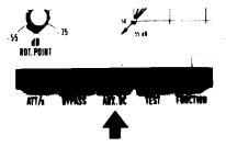
Wenn diese Taste gedrückt ist, läßt sich der Verstärkungsgrad des Kompressors mit Hilfe einer externen Gleichspannung verändern. In diesem Betriebszustand kann das Gerät für eine automatische, vorprogramierbare Verstärkungsregelung eingesetzt werden.
